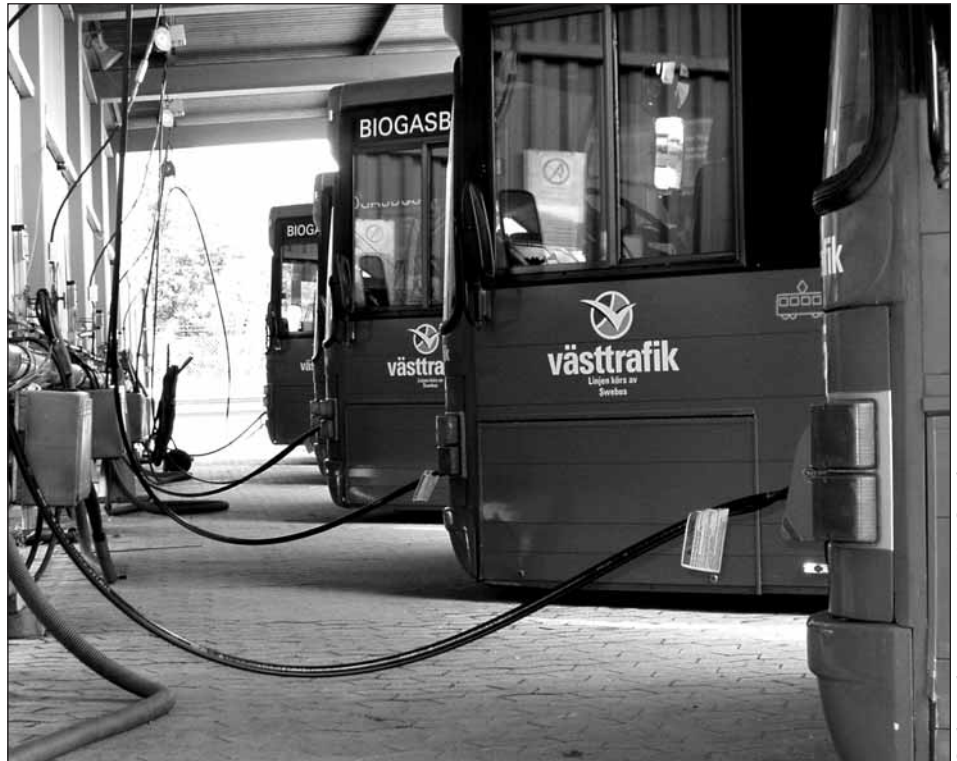
Parc municipal complet d'autobus roulant au biogaz et chauffés par énergie issue de déchets incinérés
