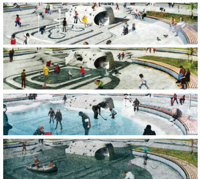
Utilisation annuelle et fonctionnelle du bassin de rétention Water Squares de Rotterdam, Pays-Bas Crédit : De Urbanisten, Rotterdam
